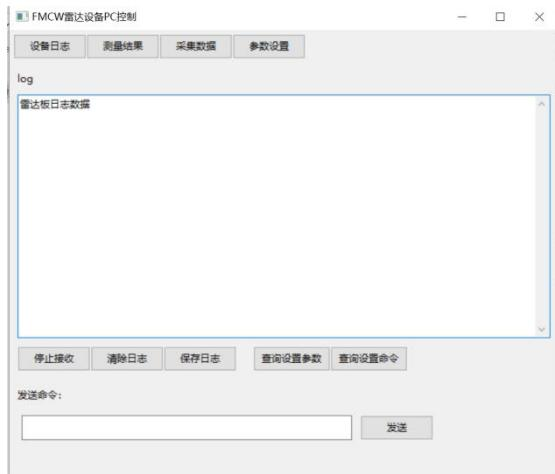
3.点击“测量结果”，接收并显示雷达板检测目标的输出数据
